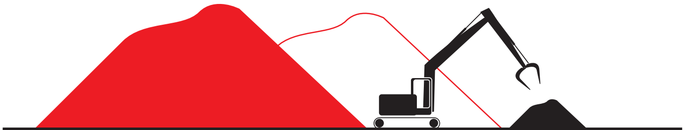
Tri à la pelle mécanique au sol
