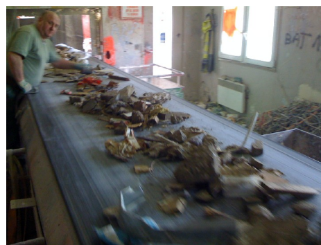
tri manuel chez STAR : sur l'image, une personne travaille plein temps pour ôter les fragments silico-calcaires du flux de matériaux
