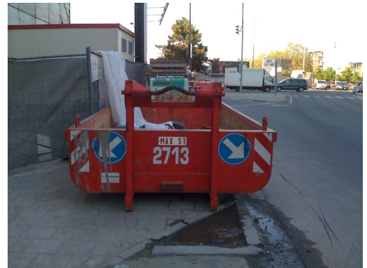
La prise d'accrochage des containers "hook lift", marque de fabrique du standard de facto bruxellois
