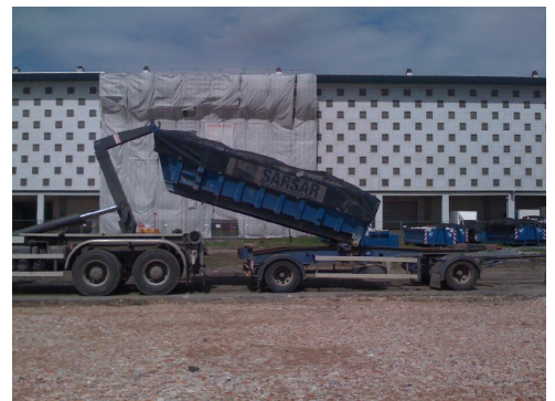
Container déplacé d'une remorque vers un camion, au moyen du bras à crochet - Bruxelles
