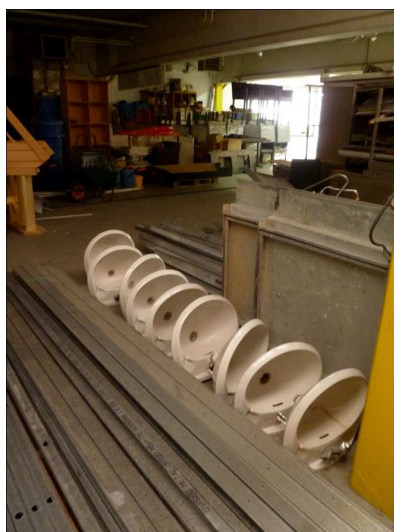
Illustration 78 : A) Vue générale du stock de All-in-Build – B) Quelques éléments du stock, dont des raccords de tuyaux en PVC – C) Récupération de lavabos et de metalstuds pour cloisonnage en panneau de carton-plâtre – D) Récupération de portes diverses
