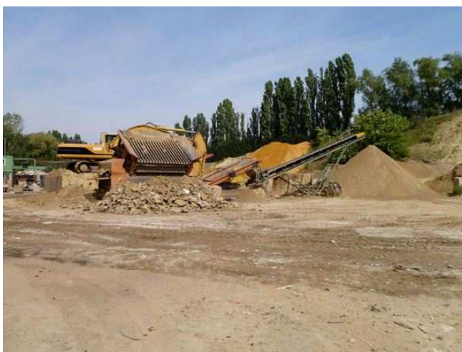
Illustration 55 : Tamisage des inertes, pour en extraire la poussière et le sable
