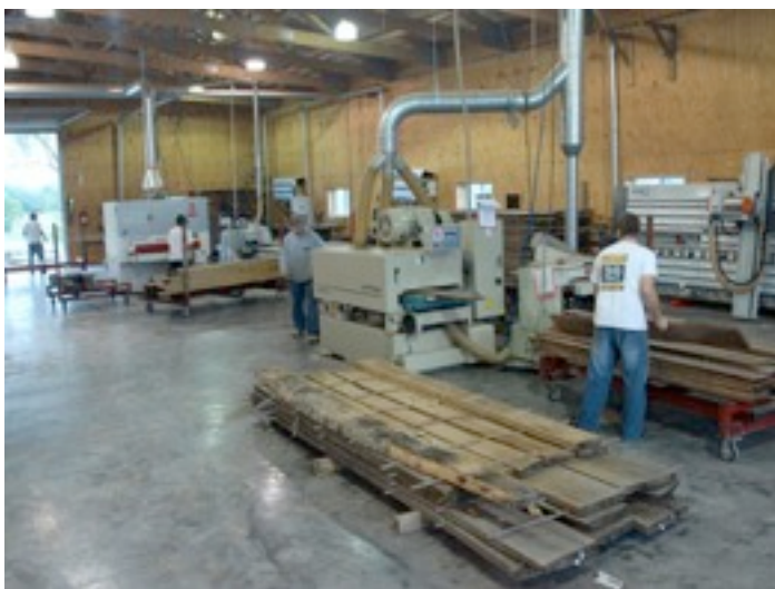
Pour la fabrication de plancher, le bois est coupé, rainuré, raboté, et finalement poncé.
