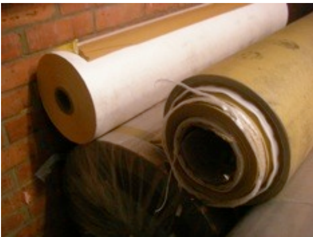
Divers types de déchets issus de l'industrie. Du haut vers le bas: 1. une erreur d'impression sur bâche 2. un rouleau de ruban adhésif disqualifié 3. des fins de rouleaux de papier laminé
