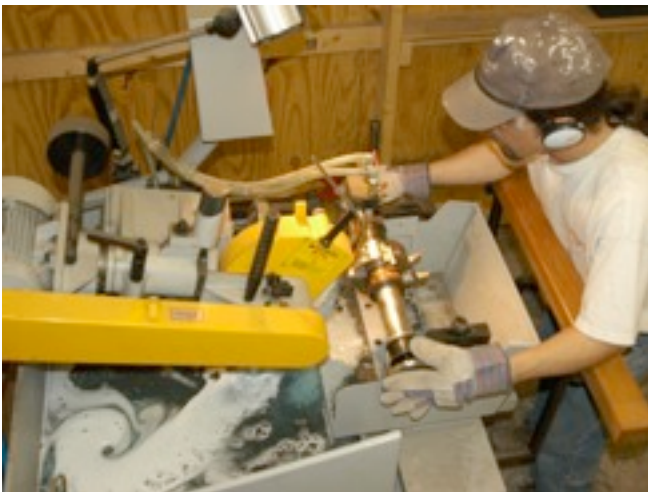
Pour aiguiser des différents outils de découpe, l'entreprise possède une machine-outil spécifique. Celle-ci permet aux ouvriers de réparer leurs propres lames, et permet un fonctionnement en toute indépendance.
