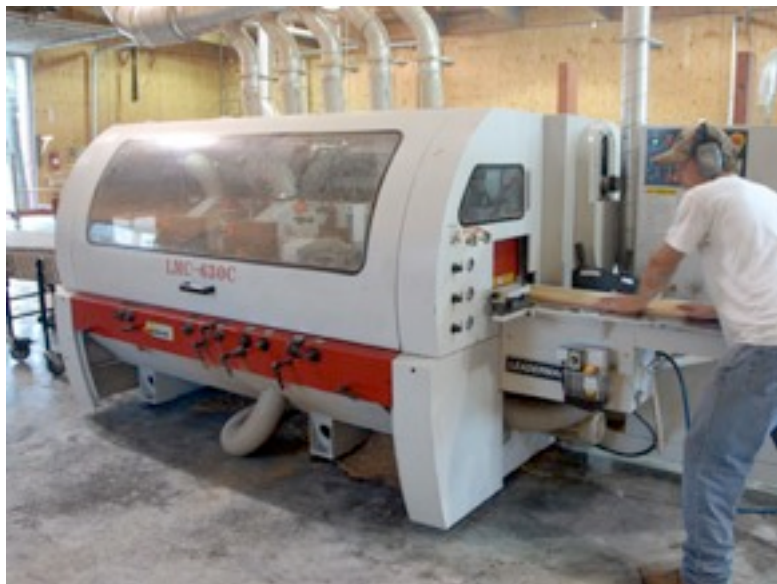
Pour la fabrication de plancher, le bois est coupé, rainuré, raboté, et finalement poncé.
