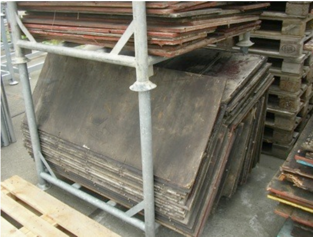
Déchets de panneaux de bois provenant d'une entreprise qui loue des éléments préfabriqués pour le coffrage de constructions en béton.
