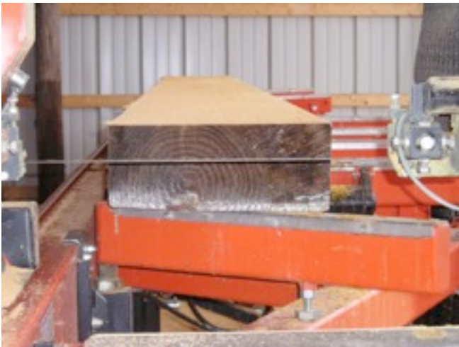
Les poutres sont équarries à l'aide d'une scie à ruban
