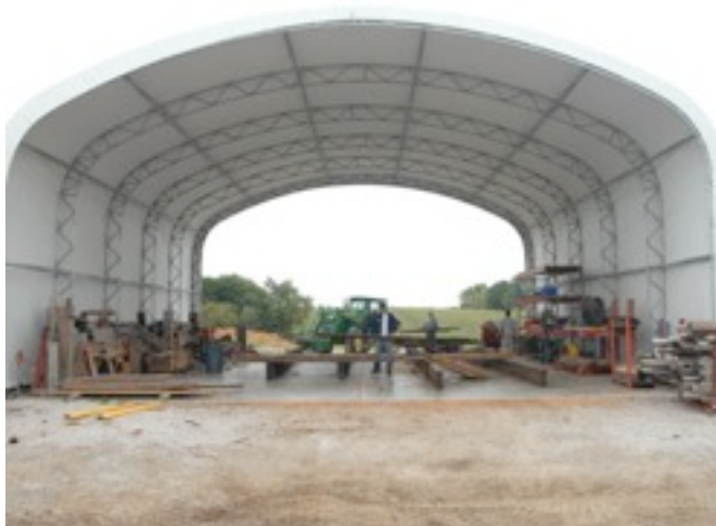
La première étape de travail est l'enlèvement des fixations métalliques. Ce travail, qui se fait sous un auvent, constitue une étape cruciale, car un clou oublié peut endommager une machine, ou blesser un ouvrier.
