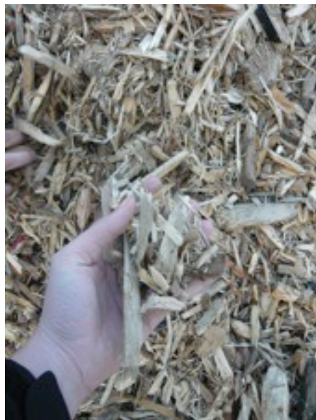
Le bois massif est principalement recyclé dans la production de panneaux en bois aggloméré. Pour faciliter le transport, le bois est souvent préalablement broyé.
