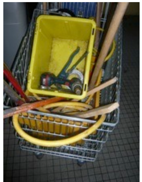
Bouwcarrousel NV (NL) démonte les éléments réutilisables avant la démolition des parties structurales. L'équipement se limite à quelques outils et une visseuse par ouvrier.
